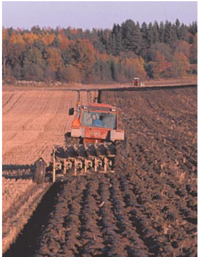
Figur 13.1 Nedplöjning av ett förorenat ytskikt begränsar de radioaktiva ämnenas växttillgänglighet genom inblandning i en större jordvolym och cesiumfixering i mineraljord.
